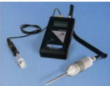
疏水阀检测仪 通过监测超声波和温度来监测疏水阀的工作的工作状态
